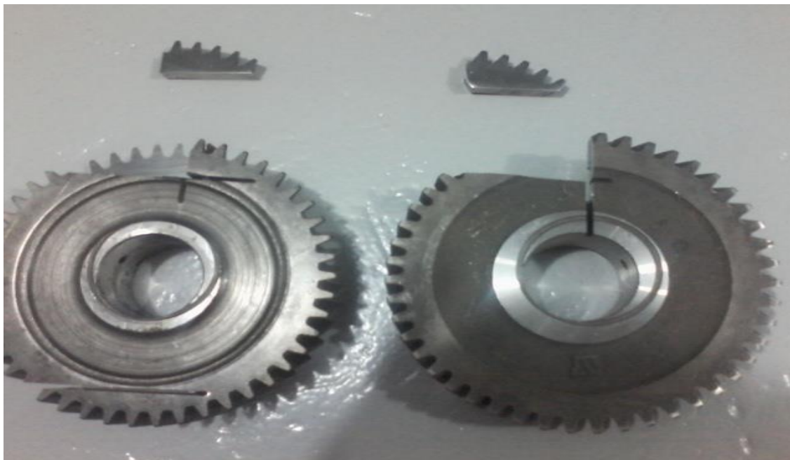
Fonte: próprio autor (2014) FIGURA 4 – Engrenagem da esquerda original, Engrenagem da direita Similar e amostras sucessivamente.
